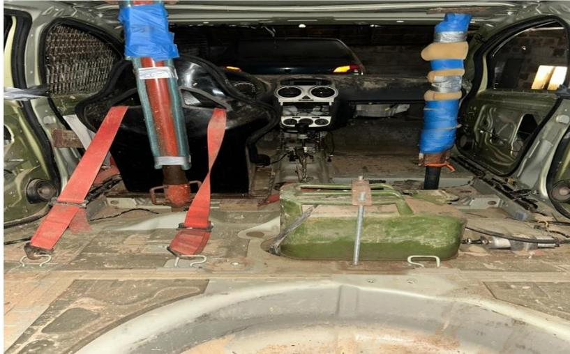
Les deux étais doivent être reliés par une barre au dessus du toit qui sera boulonnée avec les étais
