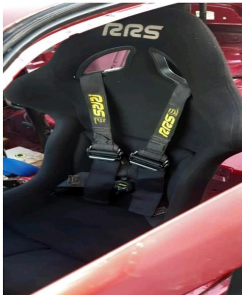
Ce dernier doit être bien fixé à la caisse et doit passer entre l'appui-tête.
