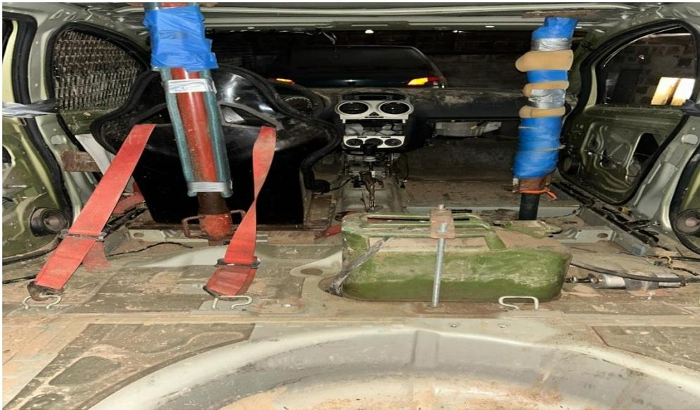
Les deux étais doivent être reliés par une barre au dessus du toit qui sera boulonné avec l'étais
